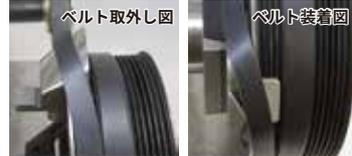
ストレッチベルトの脱着作業に使用する汎用ツールです。
